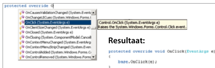
Visual Studio 2005 biedt erg prettige ondersteuning om virtuele methodes te overschrijven. Het keyword override activeert de IntelliSense -functie, die je alle in de huidige klassencontext overschrijfbare elementen op een bordje aanbiedt en vervolgens complete methodengeraamtes genereert, inclusief de oproep van de base-versie.
